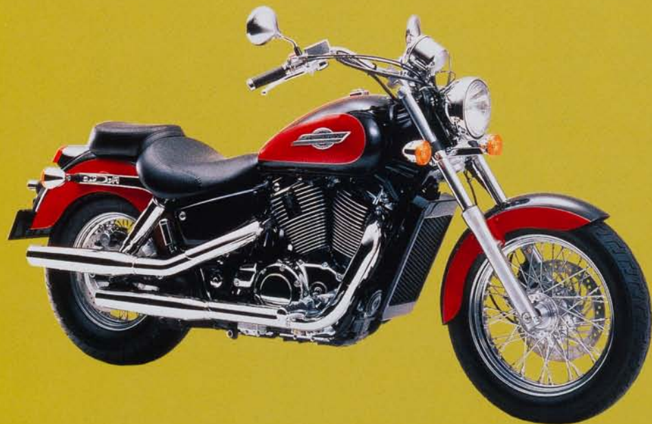
VT 1100 C2 Motore: Bicilindrico SOHC a 45°, 4 tempi, 6 valvole, raffreddato a liquido. Cilindrata: 1099,2 cc. Potenza Max: 50,3 cv a 4.500 giri/min (DIN). Peso a Secco: 260 Kg.
